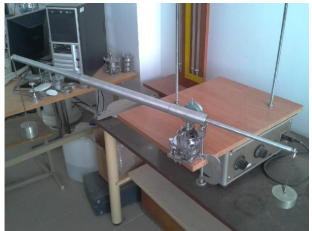
24 pav. Grunto spūdumo bandymas veikiant bandinį 50 Hz dažnio vibracijomis
