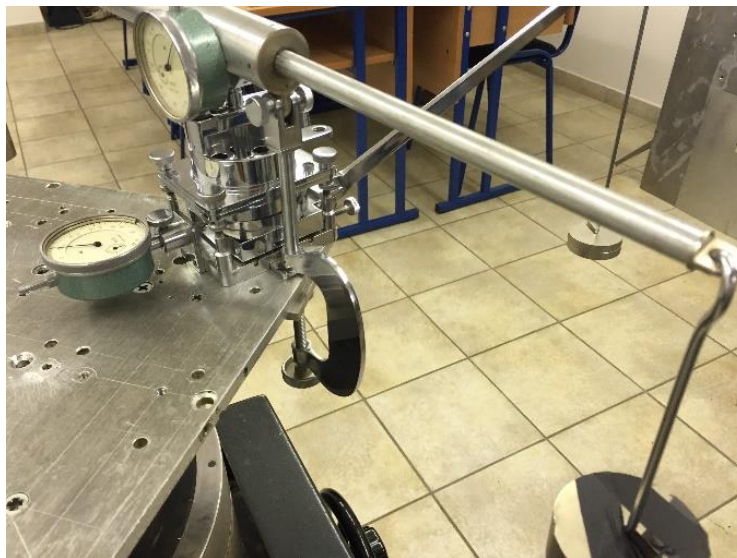
30 pav. Kirpimo bandymas veikiant bandinį 10 ir 30 Hz dažnio vibracijomis
