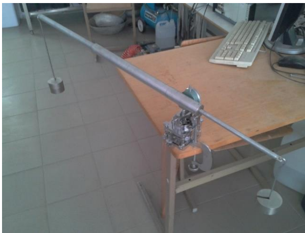
23 pav. Grunto spūdumo bandymas įprastomis sąlygomis
