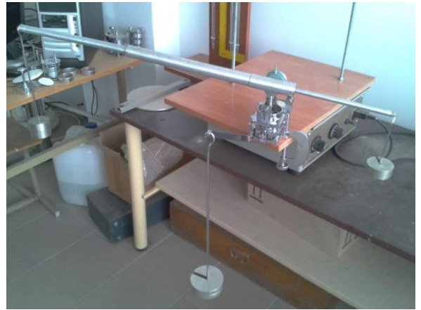
29 pav. Kirpimo bandymas veikiant bandinį 50 Hz dažnio vibracijomis
