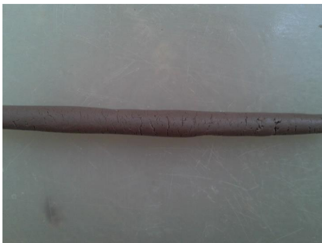
19 pav. Plastiškumo drėgnio grunto volelis
