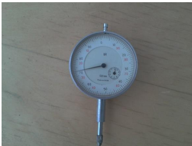
25 pav. Indikatorius deformacijoms matuoti
