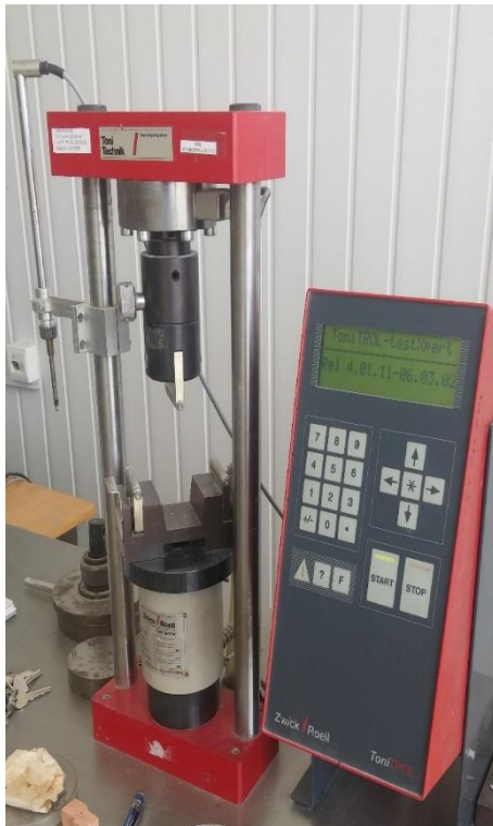
Pav.21 Hidraulinis presas Toni Technik 2020 pritaikytas lenkimo bandymams
