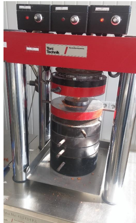
Pav.22 Hidraulinis presas Toni Technik 2020 pritaikytas gniuždymo bandymams
