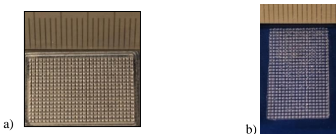
3.6 pav. Piramidinė matrica (a) ir piramidinė matrica, išspausa į polikarbonatą (b)
