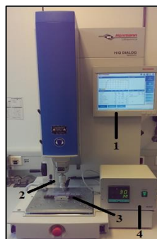
2.2 pav. HiQ DIALOG 1200 ultragarsinio karštojo spaudimo įrenginys: monitorius (1), sonotrodas (2), matrica su polimeru (3) ir kaitinimo įrenginys (4)
