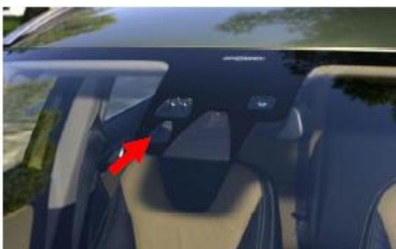
2 pav. „City Safety“ sistemos radarų montavimo vieta [6]
