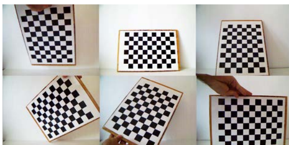
35 pav. Kamerų kalibravimas panaudojant šachmatinę plokštumą
