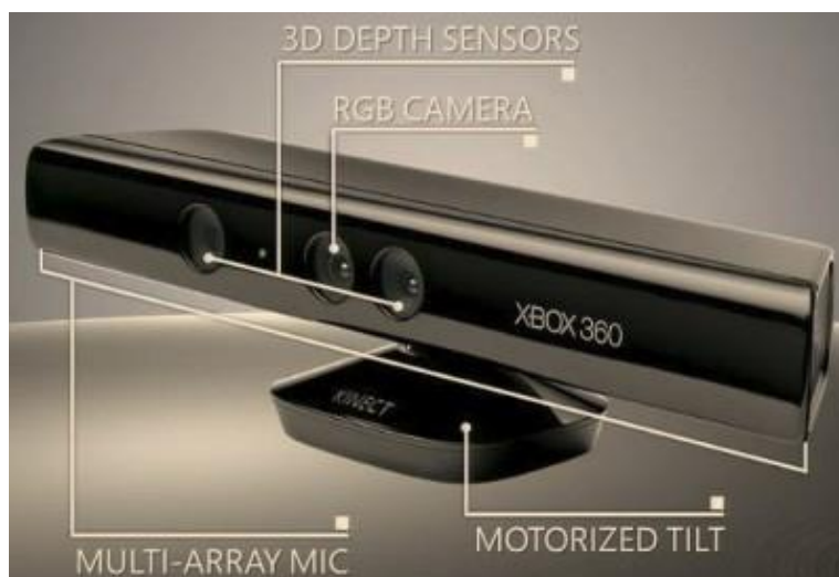
3 pav. Kinect jutikliai. Šiame pav. pažymėti visus jutikliai, kurie yra Kinect, kaip 3D gylio kamera (IR projektorius ir IR kamera), RGB kamera, mikrofonų masyvas ir motorizuotas tentas.
