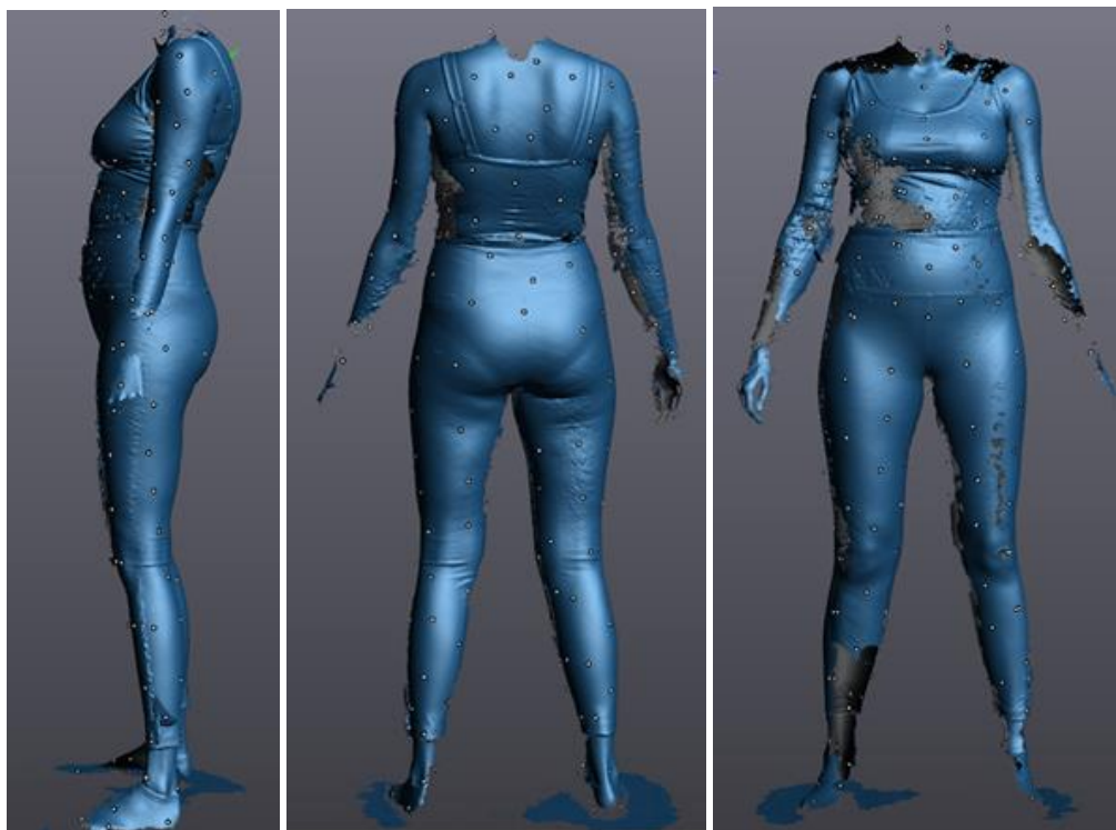
1 pav. Skenuotas kūnas su „Creaform HandySCAN 3D 700“ skeneriu [32]
