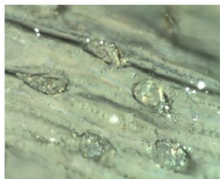
3.19 pav. Optiškai 10 ir 100 kartų padidinto pirolizuotų 400 °C temperatūroje medžio dalelės, medžio granulės ir šiaudų granulės paviršiaus nuotraukos
