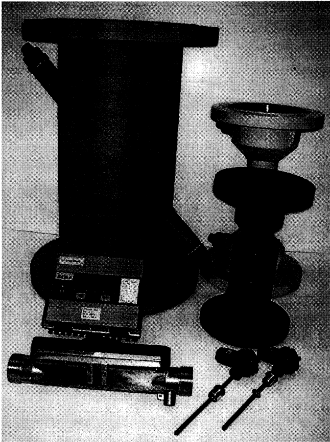
Fig. 2. Multifunctional ultrasonic heat meter SKU4
