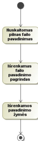
43 paveikslas. Failo pavadinimui išanalizuoti skirta valdiklio diagrama
