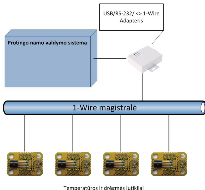
14 pav. Projektuojamos protingo namo sistemos integracijos su 1-Wire jutikliais struktūra
