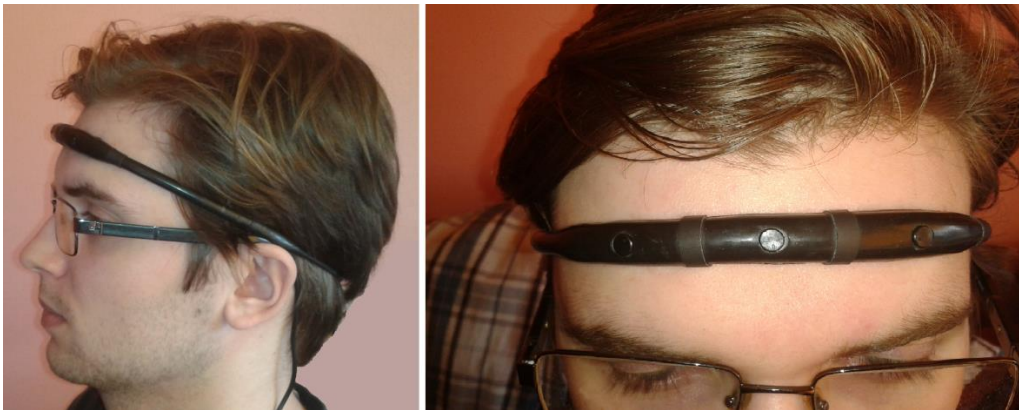
27 pav. „OCZ NIA“ įrenginio montavimo pavyzdys.
