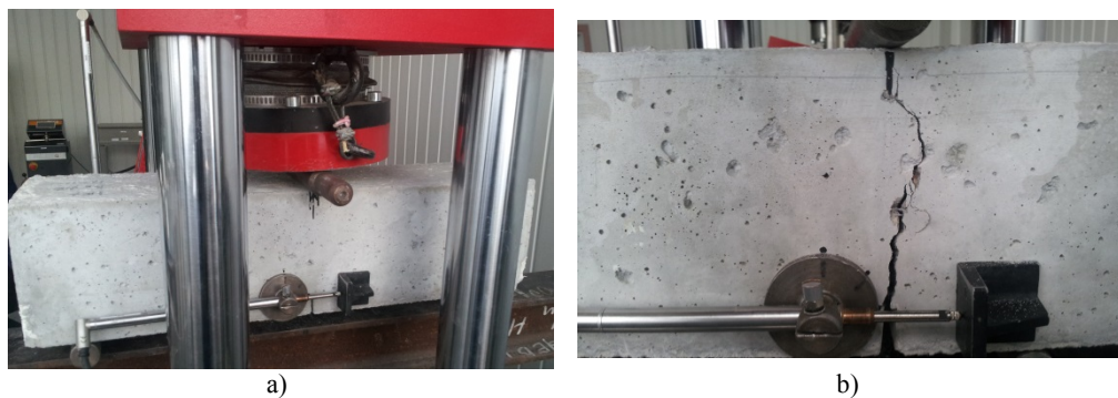
2.4 pav. Plieno plaušu ir armatūra armuotos sijelės plyšio matavimas (bandymas Nr. 3): a) bendras bandymo vaizdas; b) plyšio pločio matavimas armatūros lygyje
