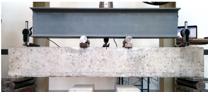
2.8 pav. Sijų lenkimo bandymas
