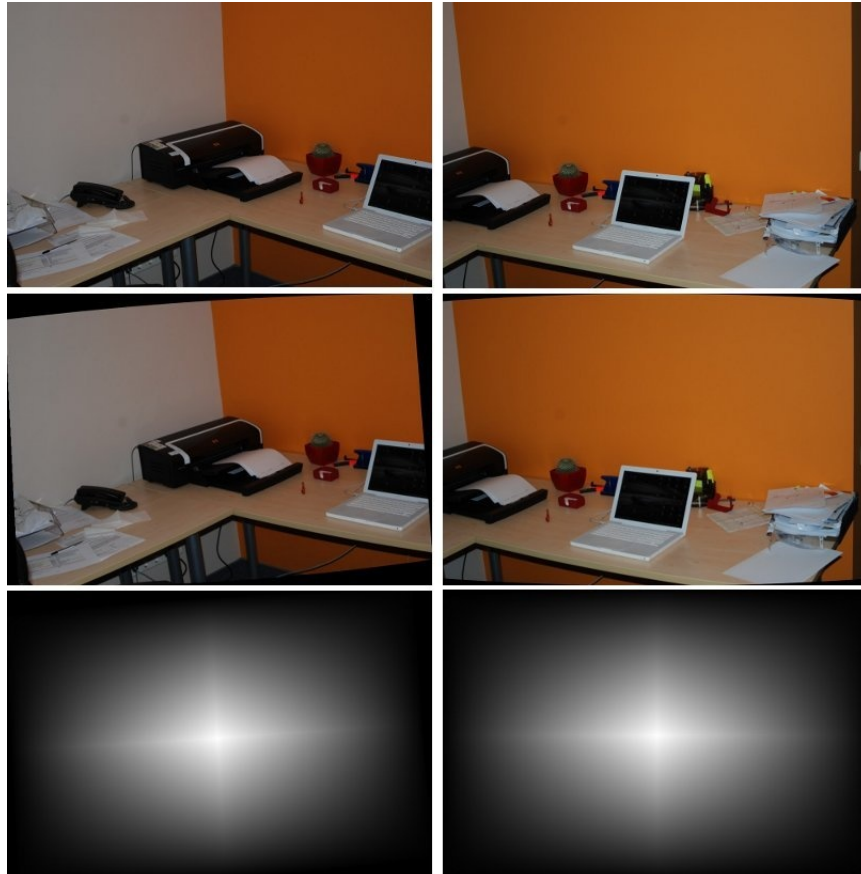
4 pav. Tiesinio vaizdų suliejimo komponentai. Pradiniai vaizdai I^i(x, y) , vaizdai bendrosė sferinėse koordinatėse I^i(\theta, \phi) , vaizdų tiesio suliejimo svoriai W^i(\theta, \phi)
