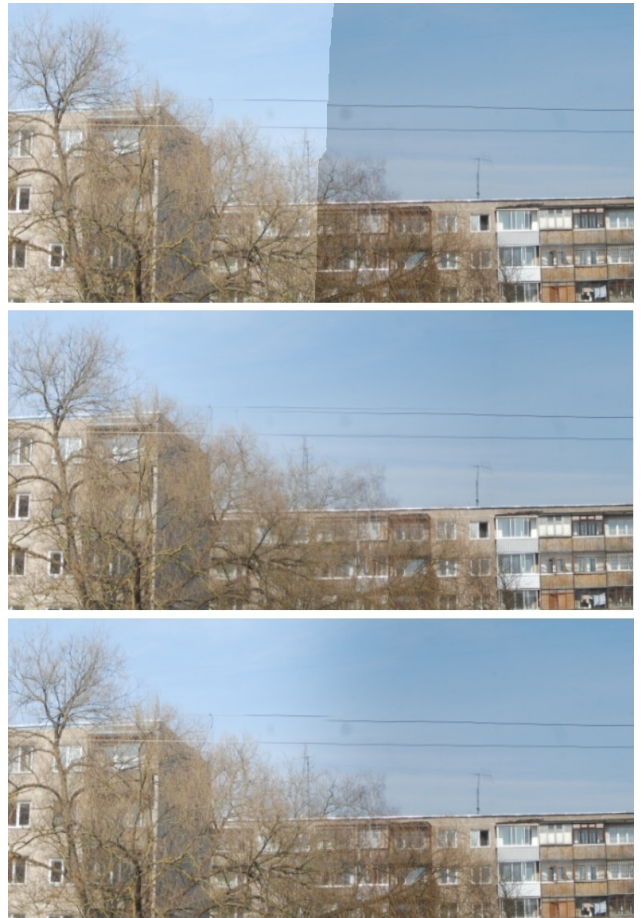
Paveikslas 4. vaizdų sujungimas be suliejimo, panaudojant tiesinį suliejimą ir panaudojant daugiajuostį suliejimą
