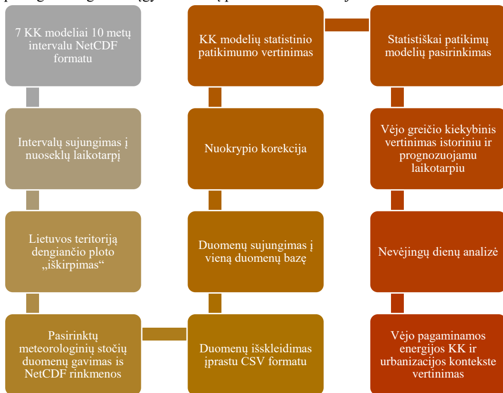
26 pav. Vėjo greičio duomenų išskleidimo ir skaičiavimo algoritmo schema
