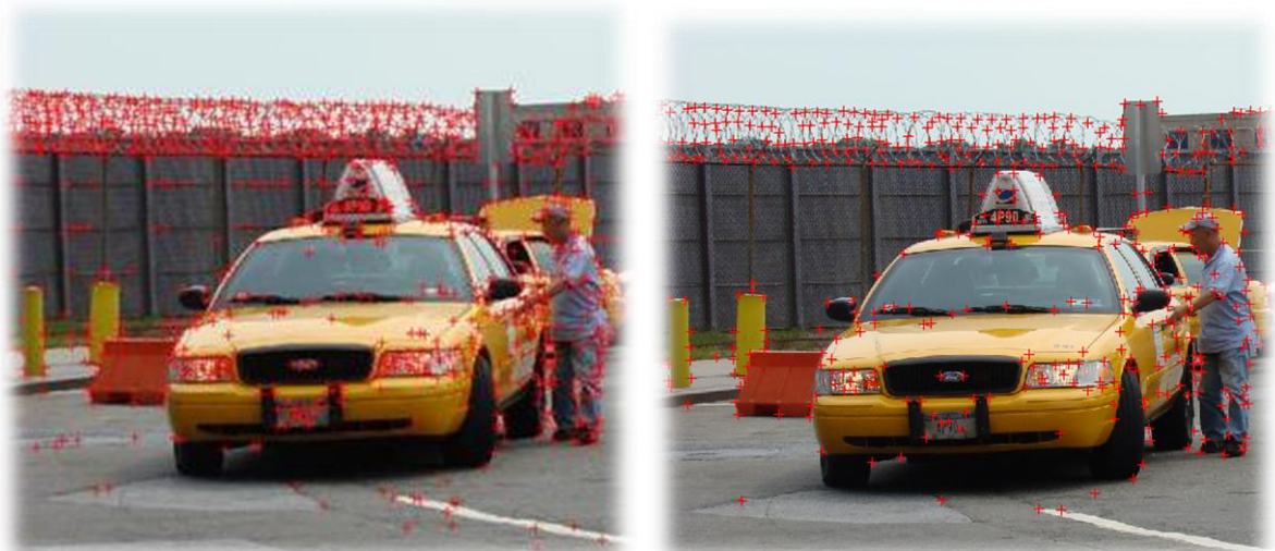
9 pav. Hario kampų metodu aptikti būdingi taškai. Kairėje naudojami parametrai:
