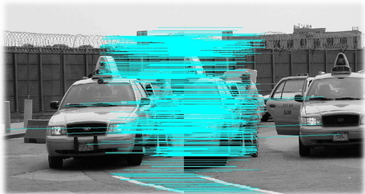
12 pav. Požymių sugretinimas SIFT. Atstumo santykis=0.6
