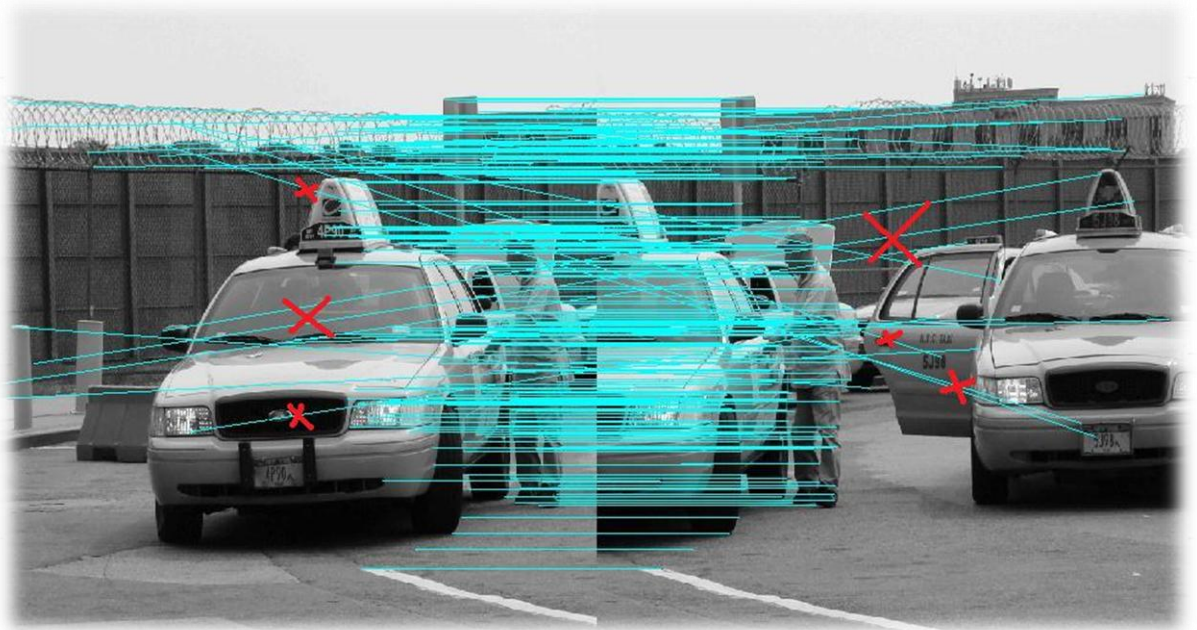
15 pav. Požymių sugretinimas naudojant sutampančias fazes
