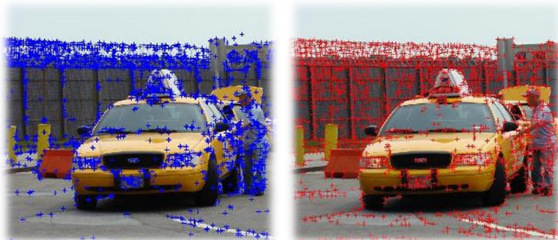
11 pav. SIFT ir Hario kampų metodais aptikti būdingi taškai. Kairėje SIFT, dešinėje Hario kampų su \sigma=1 , slenkstis=86
