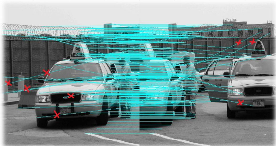
14 pav. Požymių sugretinimas naudojant koreliaciją
