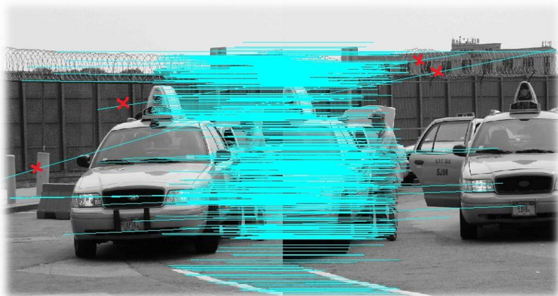
13 pav. Požymių sugretinimas SIFT. Atstumo santykis=0.7
