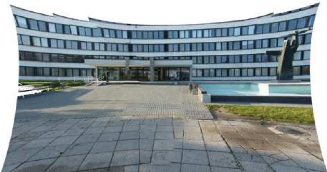
9 pav. Hugin kontrolinių nuotraukų komponavimo į panoramą rezultatas. Ryškūs nesutapimai grindinio srityje, įėjimo į pastatą srityje bei neteisinga transformacija
