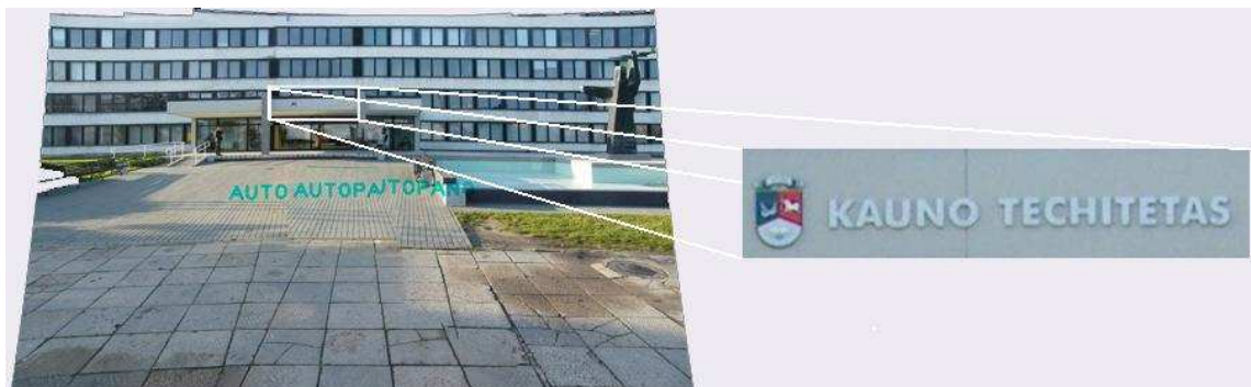
8 pav. Autopano pro 2 kontrolinių nuotraukų komponavimas į panoraminę. Vizualiai pastatas atrodo be pastebimų trūkių, tačiau prarasta dalis informacijos – užrašas virš įėjimo sutrumpėjęs. Taip pat klaidos grindinio srityje.
