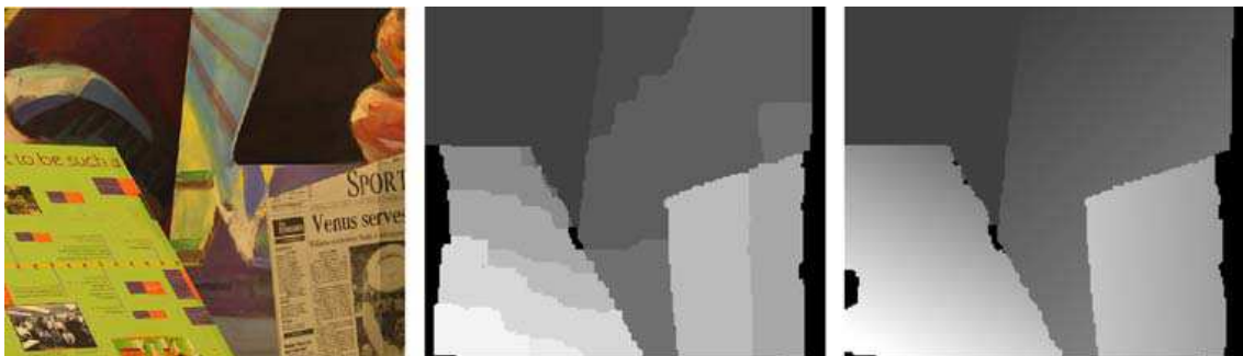
12 pav. Vienas paveikslėlis iš paveikslėlių poros, jam sudarytas gylio žemėlapis ir iš gylio žemėlapio suformuotas plokštuminis gylio paviršių žemėlapis.
