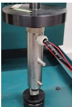
3.5 pav. Sukurtas magnostriktoriaus įrenginys
