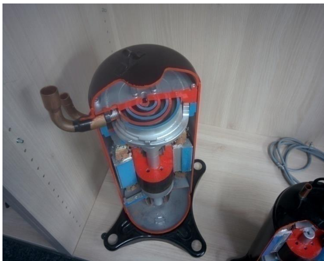
10.1 pav. Kompresoriaus pjūvis
