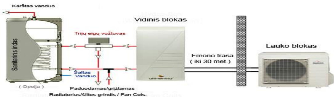
6.1 pav. Principinė schema oras / vanduo (split sistema).
