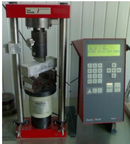
33 pav. Stiprio lenkiant bandymams atlikti naudojamas Toni Technik presas.
