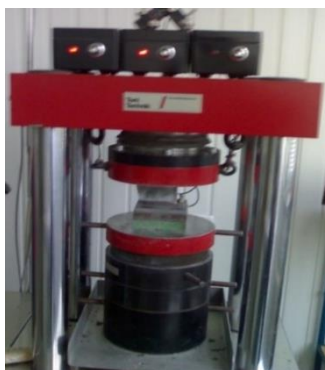
31 pav. Stiprio gniuždant bandymams atlikti naudojamas Toni Technik presas.
