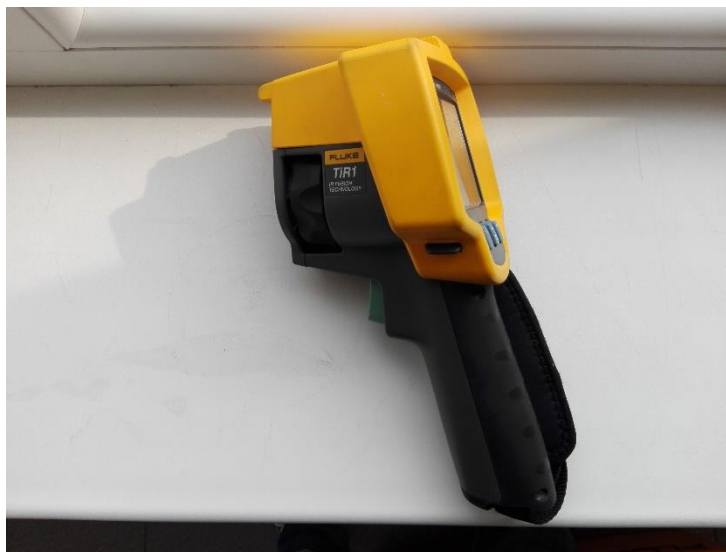
3 Pav. Termovizorius FLUKE TiR 1
