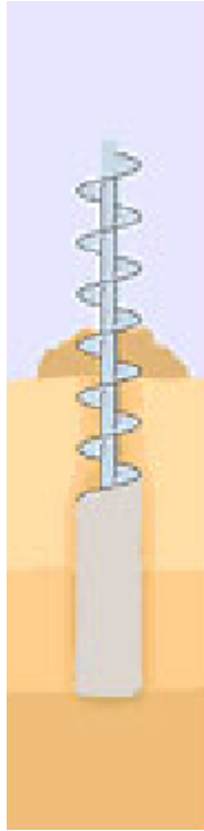
3.1.6.2 pav. grunto šalinimas iš gręžinio ir betonavimas
