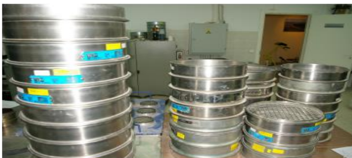
14 pav. Užpildų granulimetrinei sudėčiai nustatinėti naudojami sietai
