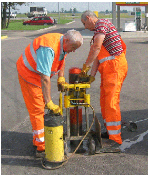
22 pav. Kerno gręžimas
