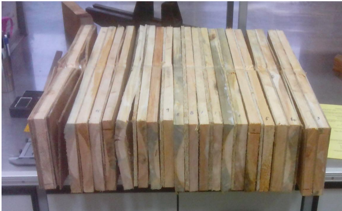
4.1 pav. Bandinių pavyzdžių dalis po lenkimo tyrimo.
