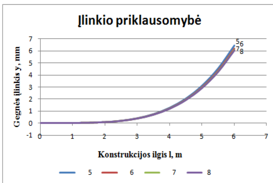
4.8 pav. Bandinių įlinkio priklausomybė nuo ilgio: 5 – medis su 8 mm orientuotų skiedrų plokšte (OSB); 6 – medis su 10 mm orientuotų skiedrų plokšte (OSB), 7 – medis su medžio plaušo plokšte (MPP kartonas), 8 – medis su trigubu medžio plaušo plokšte (MPP kartonas).
