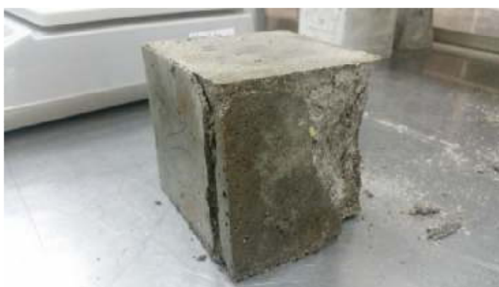
2.11 pav. Bandinių irimas po paviršių barstymo technine druska
