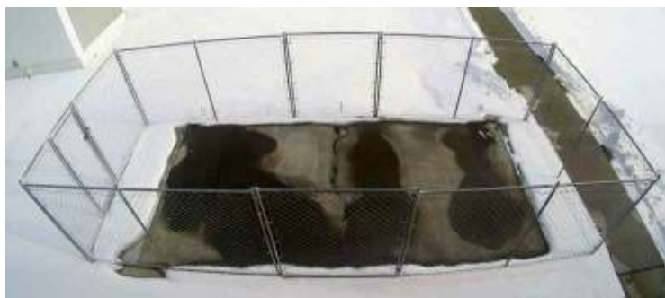
1.18 pav. Elektrai laidus betonas tirpdo sniegą
