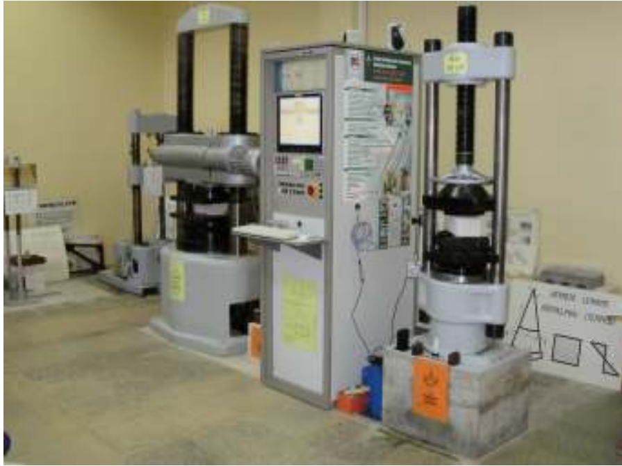
2.2 pav. 2500 kN galios presas
