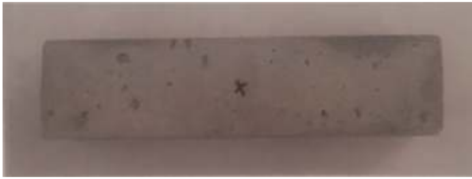
1.5 pav. Bandinys, mirkytas NaCl tirpale
