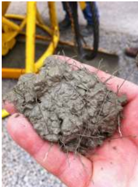
1.16 pav. Betonas su metalo pluoštu
