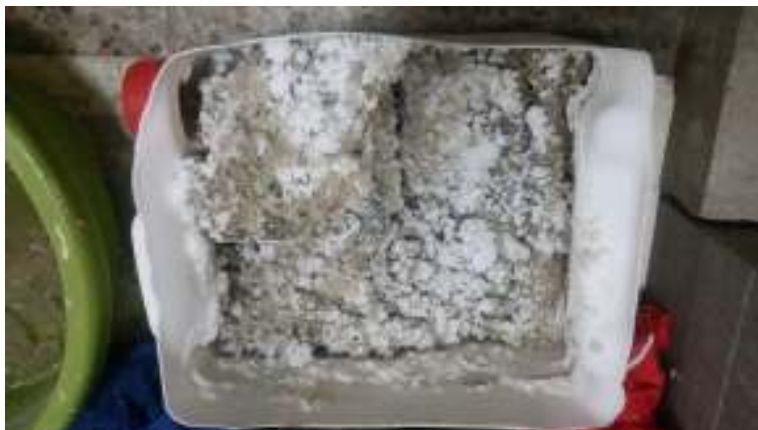
1.3 pav. Druskos kristalai, susidarę betono bandinių paviršiuje
