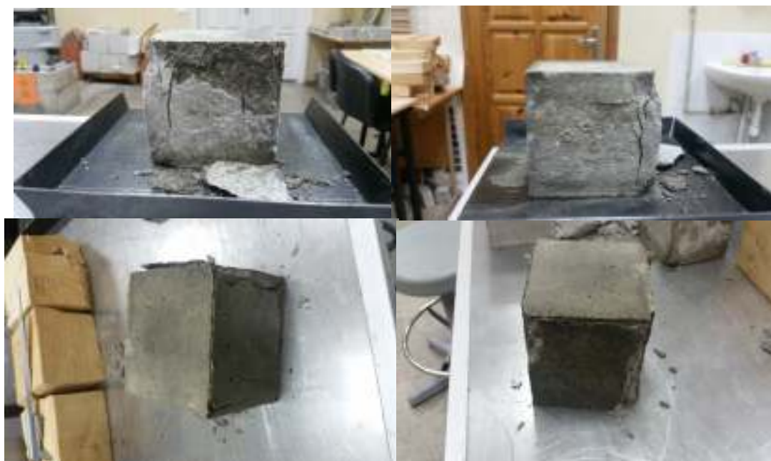
2.12 pav. Bandinių irimas po laikymo jūrinį klimatą primenančiomis sąlygomis
