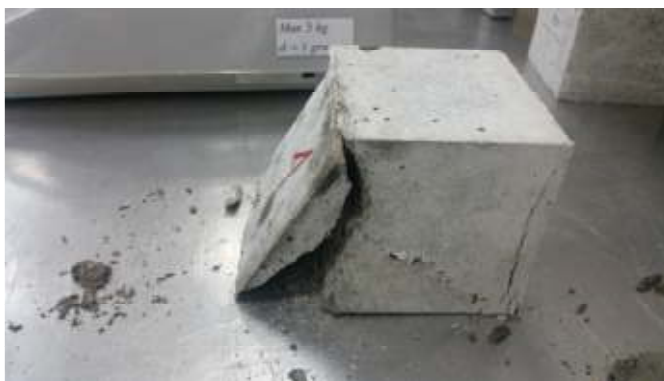
2.9 pav. Bandinių irimas po šaldymo
