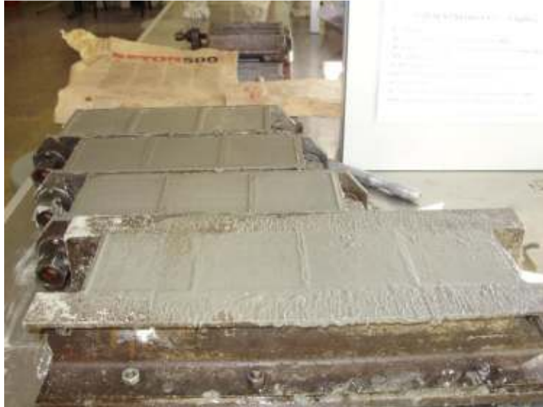
2.1 pav. Betono bandinių gamyba
