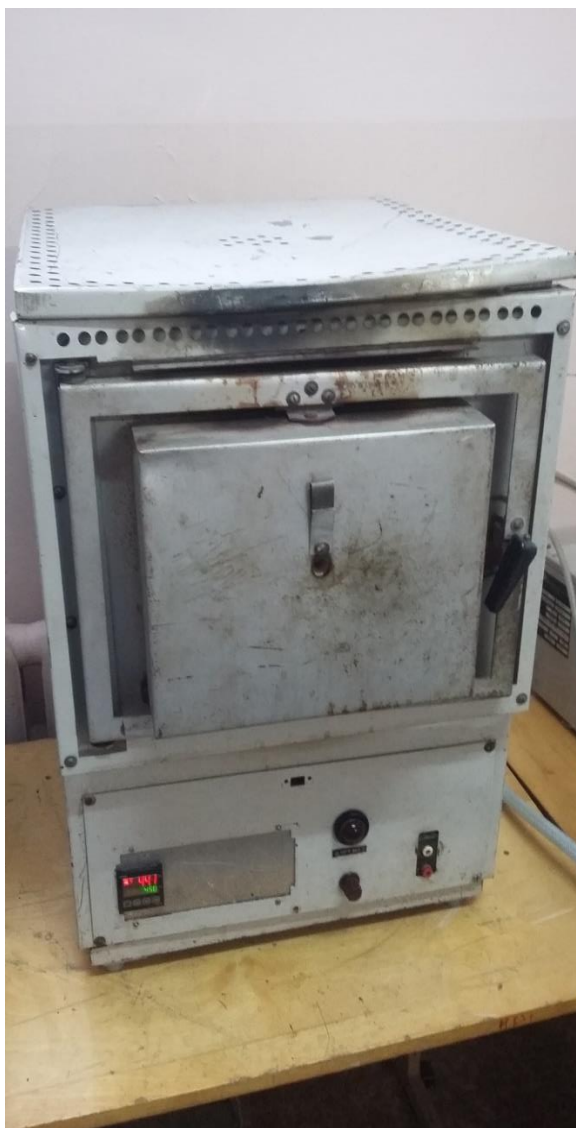
3.8 pav. Reguliuojamos temperatūros krosnelė CHOJI-1.6.2,5.1/11-M1 Y4.2
