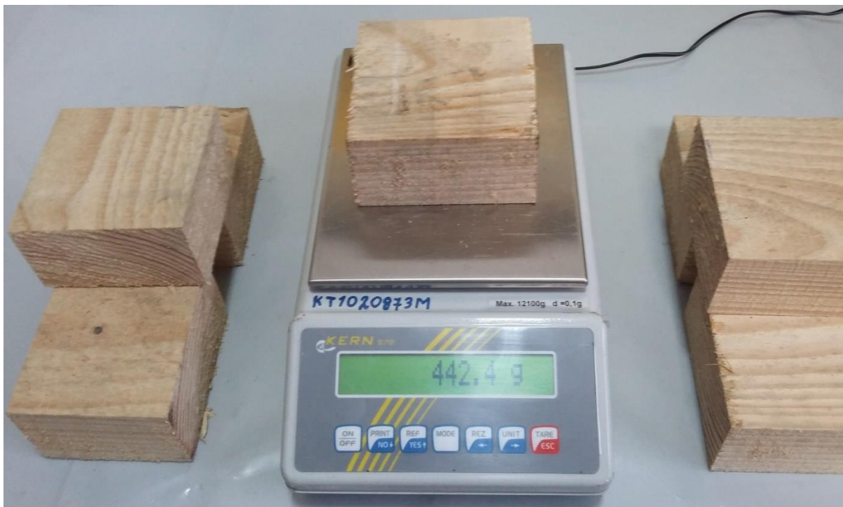
3.2 pav. Bandinio svėrimas po džiovavimo.
