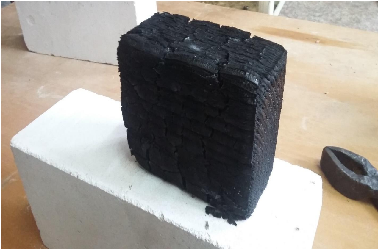
3.9 pav. Užgesintas neimpregnuotos medienos bandinys, 450°C temperatūroje užsiliepsnojęs po 157 s.
