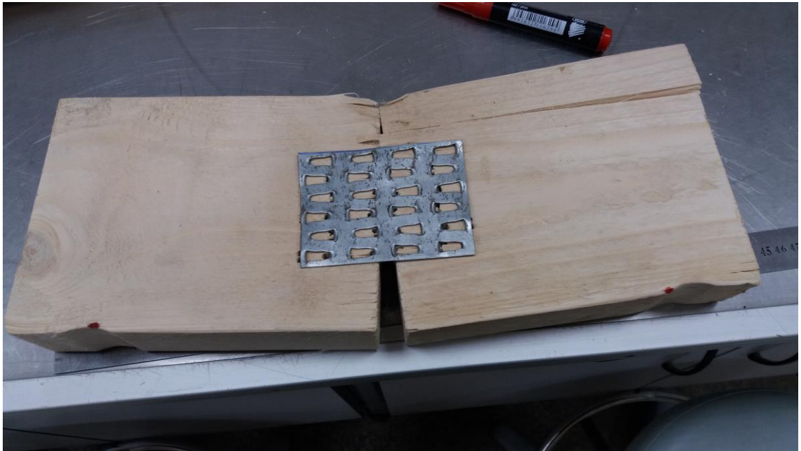
32 pav. Metalinės dygliuotos plokštelės deformacija atlikus antrąjį bandymą.
