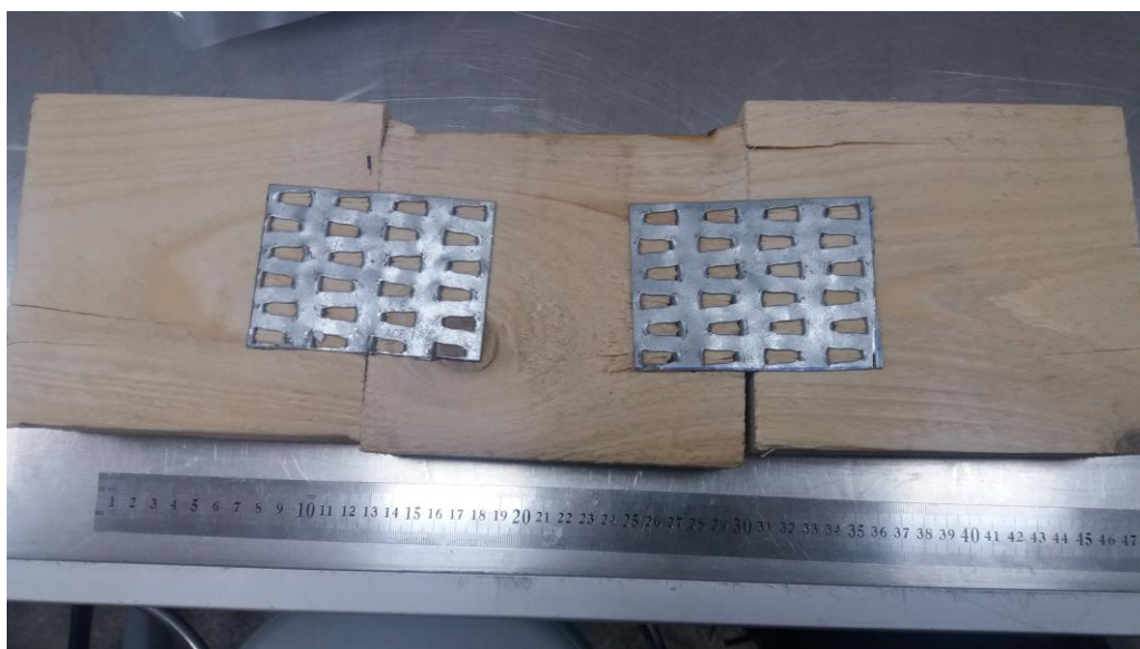
19 pav. Metalinės dygliuotos plokštelės deformacija atlikus trečiąjį bandymą.
