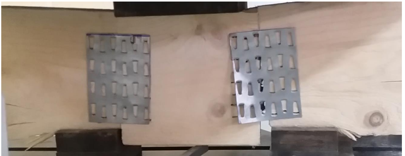
11 pav. Metalinės dygliuotos plokštelės deformacija atlikus pirmąjį bandymą.
