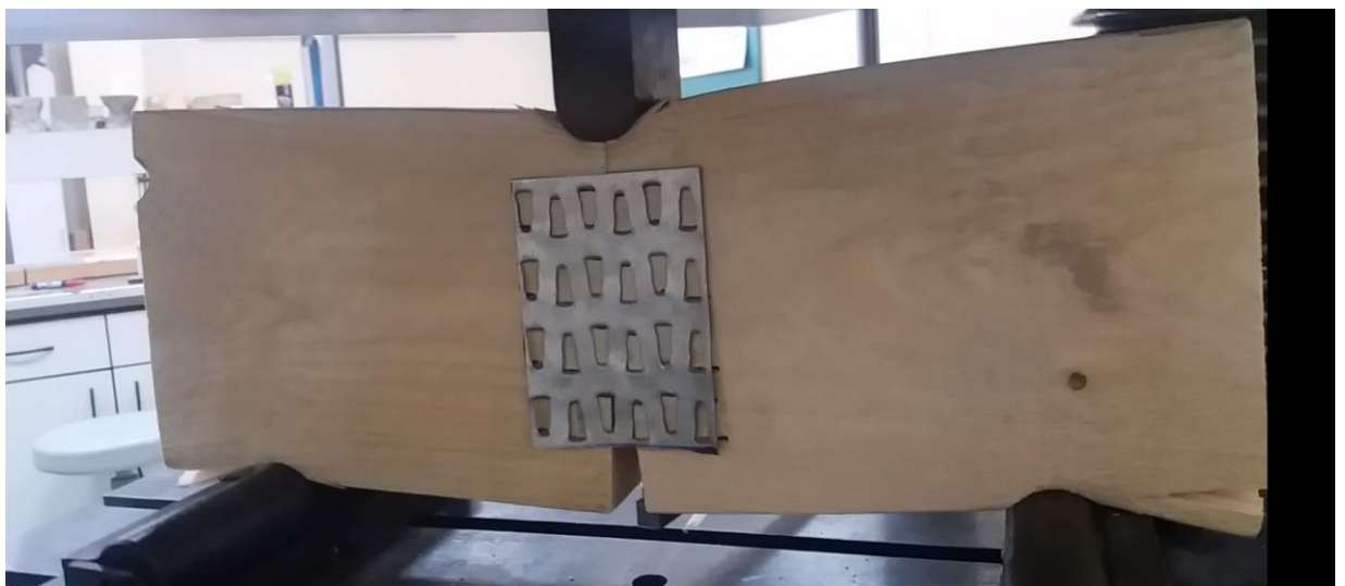
28 pav. Metalinės dygliuotos plokštelės deformacija atlikus pirmąjį bandymą.
