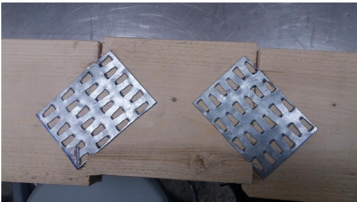
23 pav. Metalinės dygliuotos plokštelės deformacija atlikus ketvirtąjį bandymą.
