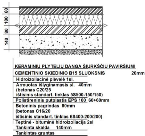
2 pav. Keraminių plytelių neslidžiu paviršiumi konstrukcijos mazgas
