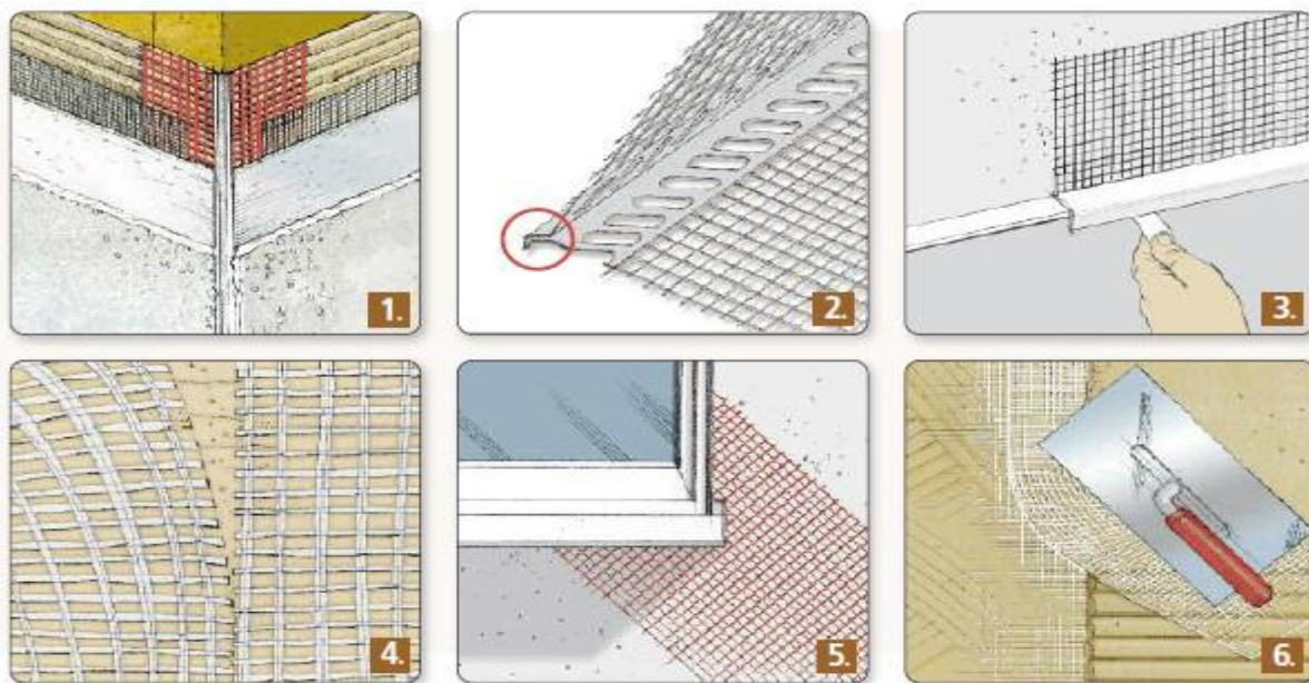
14 pav. Armuojančio sluoksnio įrengimas
