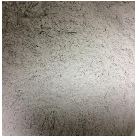
7.1 pav. Sumaltas kvarcinis smėlis S=3000 \text{ cm}^2/\text{g}
