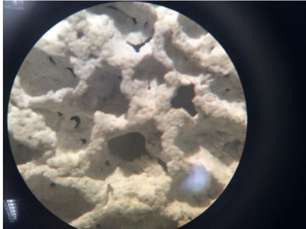
7.10 pav. Akyto betono bandinys su 1% priemaišų
