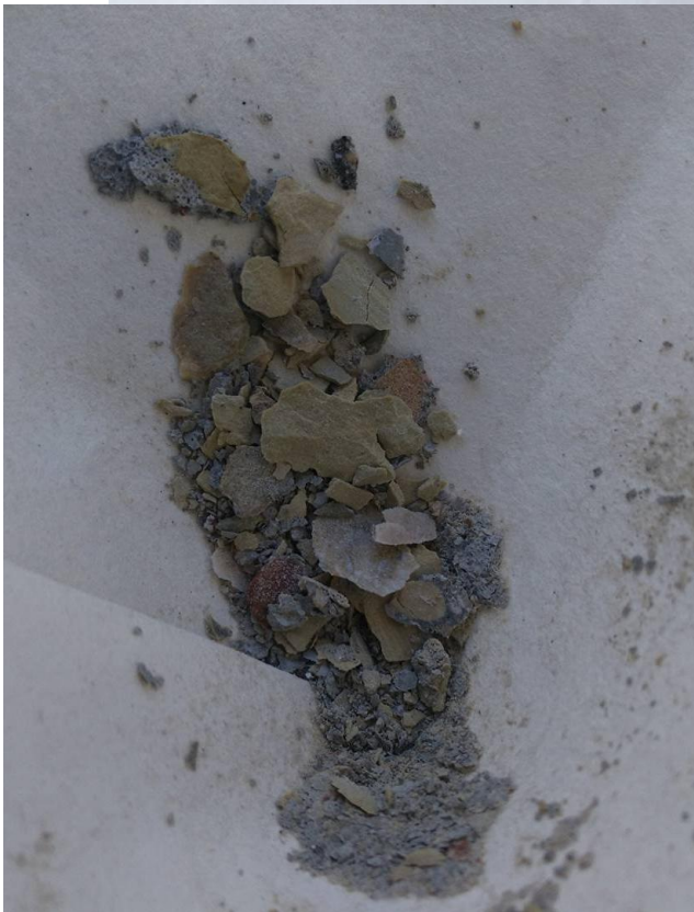
2.11 pav. Masės nuostoliai ant filtriukų.
