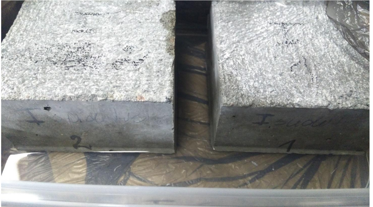
2.7 pav. Pamerkti, I B sudėties perpjauti bandiniai, į \text{Na}_2\text{SO}_4 tirpalą.
