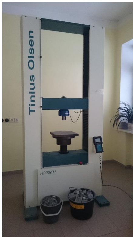
2.4 pav. Gniuždymo stiprio nustatymui naudotas hidraulinis presas
