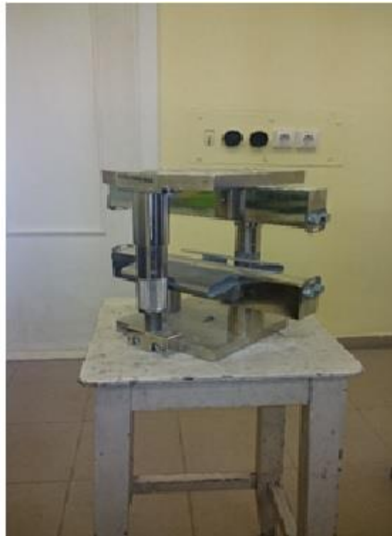
2.5 pav. Tempimo stiprio skeliant bandymo principas (LST EN 1338:2003+AC:2006)
