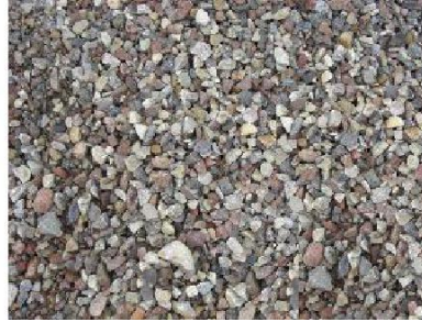
2.1 pav. Smėlis fr. 0/4, žvirgždo skalda fr. 2/8, granito skalda fr. 2/8
