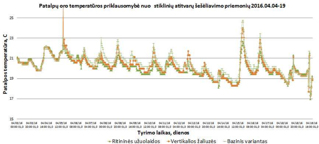
5 pav. Patalpų oro temperatūros priklausomybė nuo stiklinių atitvarų šešėliavimo priemonių 2016.04.04 – 19.
