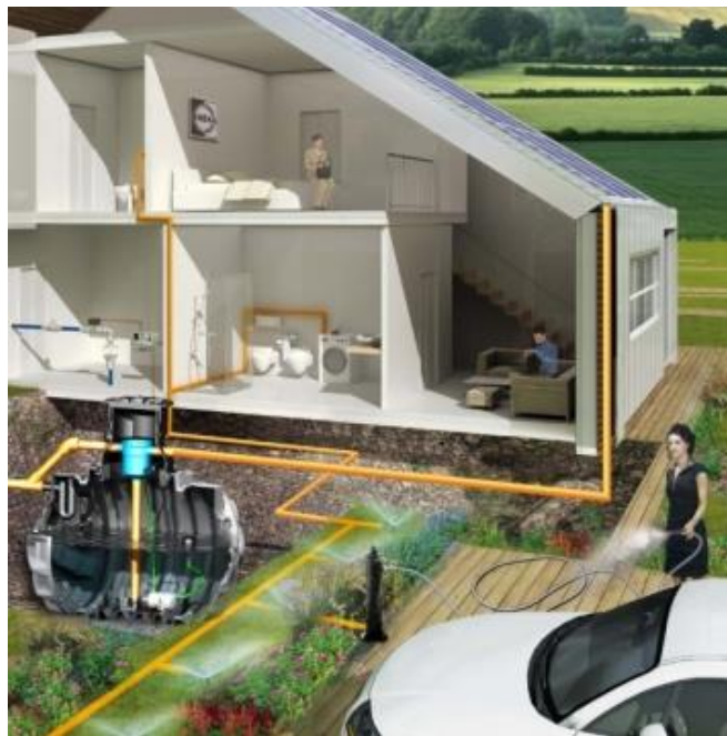
2 pav. Gyvenamasis namas su lietaus vandens naudojimo sistema. [14]
