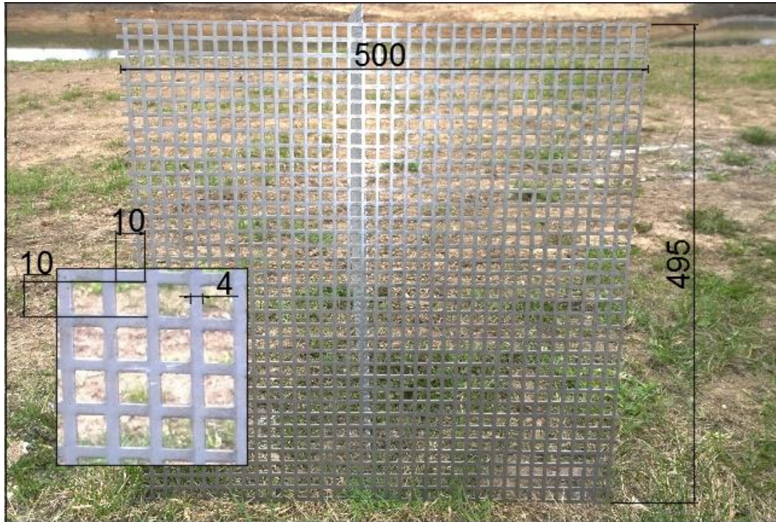
9 pav. Perforuotos skardos lakštas su kvadrato formos skylutėmis.
