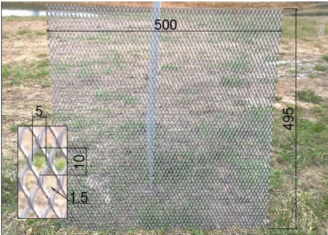
8 pav. Perforuotos skardos lakštas su rombo formos skylutėmis.
