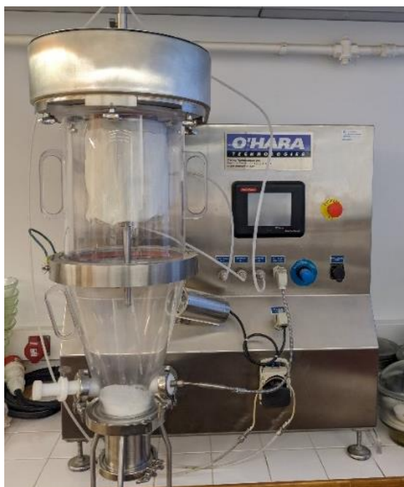
2.1 pav. Laboratorinis pseudo-verdančio sluoksnio dengimo įrenginys „O-Hara“
