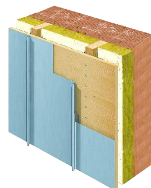
Pav. Nr. 34 Fasado konstrukcijos trimatis vaizdas
