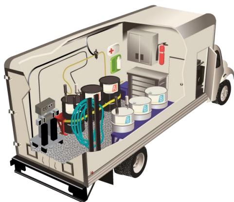
Pav. Nr. 25 Putų poliuretano purškimo įranga: kair. mobili putų purškimo stotelė, deš. Putų purškimo stotelės vaizdas iš vidaus
