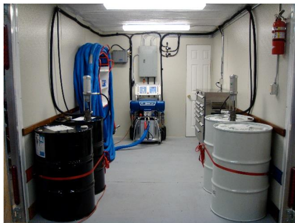
Pav. Nr. 25 Putų poliuretano purškimo įranga: kair. mobili putų purškimo stotelė, deš. Putų purškimo stotelės vaizdas iš vidaus
