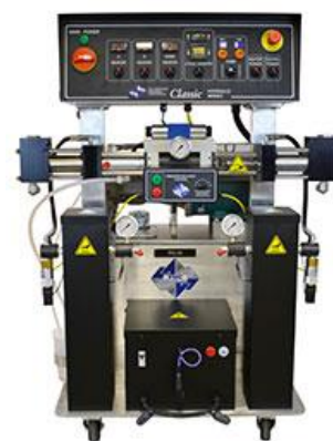
Pav. Nr. 26 Putų purškimo paruošimo aparatas „Polymac-PMC Classic“ [36]
