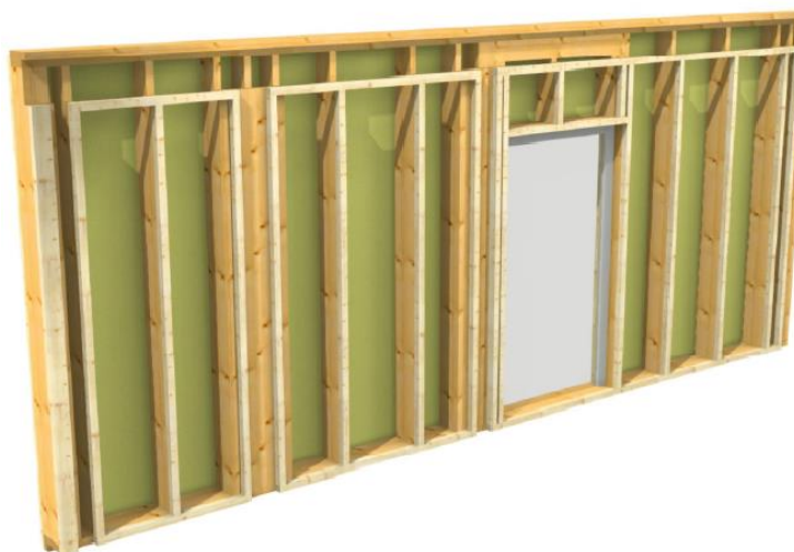
5 pav. Medinės skydinės sienos 3D maketas
