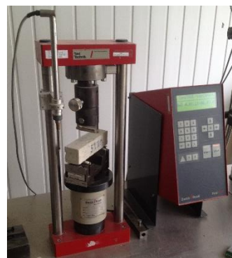
7.12 pav. Lenkimo prietaisas [49]
