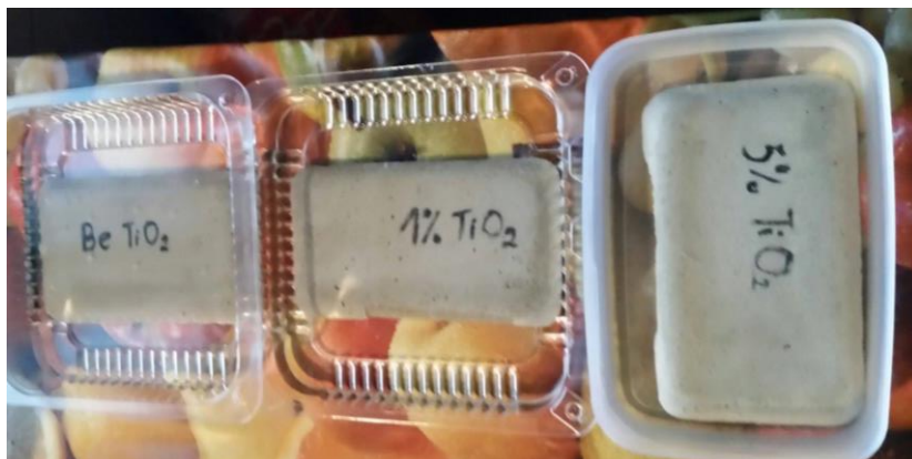
7.14 pav. Trijų skirtingų smėlbetonio mišinio plokštelių mirkymas
