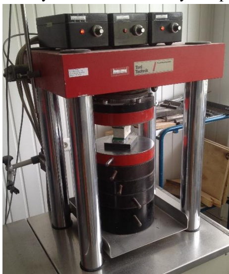
7.13 pav. Gniuždymo presas [49]
