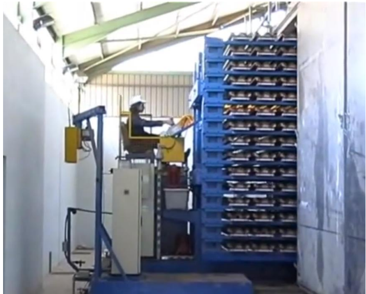
4.7 pav. Gaminių transportavimas į kietinimo kamerą [22]
