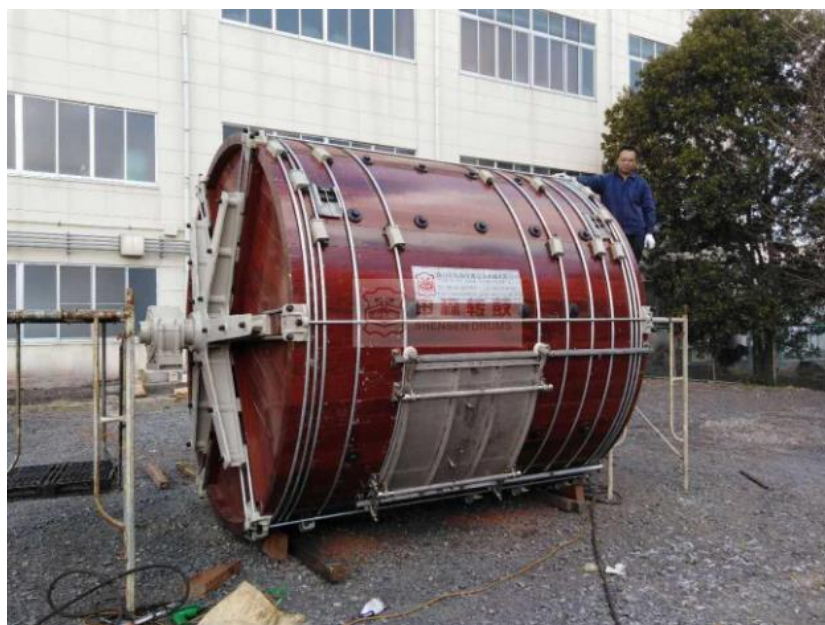
1.1 pav. Odos išdirbimo procesams naudojamas būgnas pramonėje
