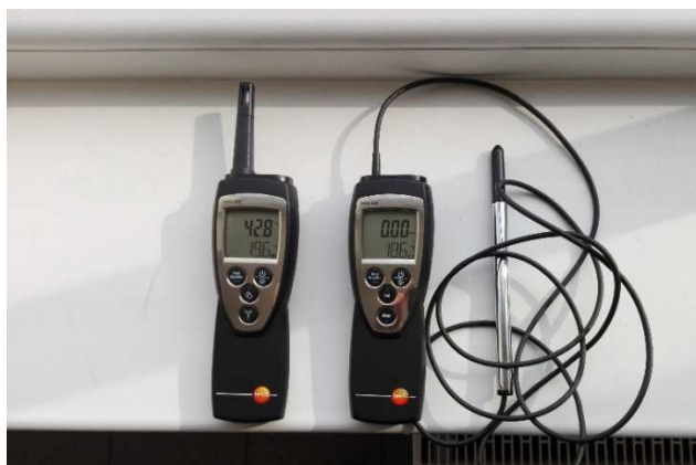
3 pav. Natūralaus vėdinimo tyrimui naudojami prietaisai. (kairėje – TESTO625, dešinėje TESTO425)
