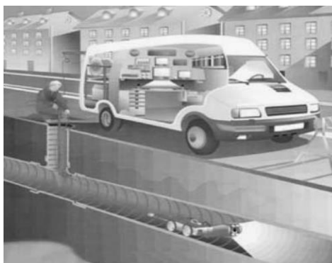
1.2 pav. CCTV kameros apžiūros proceso vaizdas betoniniame vamzdyje [3]
