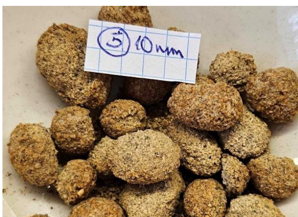
2.14 pav. 10 mm dalelių dydžio produktas gautas į KDF pridendant 5 % džiovintų lubinų lapų, 5 % celiuliozės, bei 5 % kalcio lignosulfonato, kai pradinė žaliavų drėgmė 21 %
