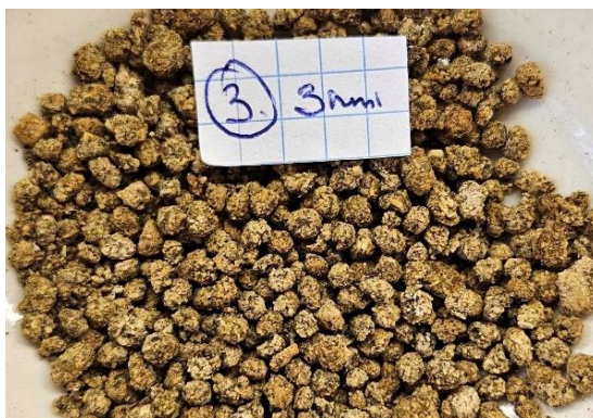
2.12 pav. 3 mm dalelių dydžio produktas gautas į KDF pridedant 15 % džiovintų lubinų lapų bei 5 % kalcio lignosulfonato, kai pradinė žaliavų drėgmė 22,5 %
