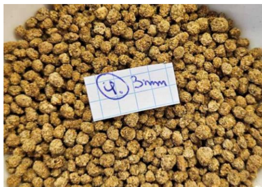
2.13 pav. 3 mm dalelių dydžio produktas gautas į KDF pridedant 5 % džiovintų lubinų lapų bei 5 % kalcio lignosulfonato, kai pradinė žaliavų drėgmė 21 %
