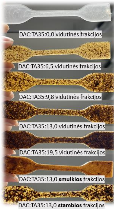
24 pav. Biokompozitų (DAC:TA35:KSL1) injekcinio liejimo suformuoti bandiniai, esant vienodam TA kiekiui kompozite
