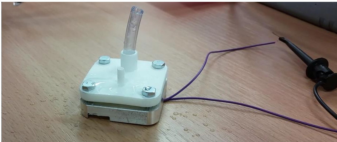
5.1.5 pav. Pjezoelektrinio siurblio bandymas, kurio kameros aukštis 0,5mm.
