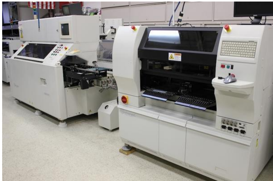
2.2 pav. Paviršinio montažo linija „Universal“ [12]
