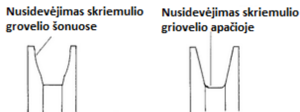
5.6 pav. Nusidėvėjusio diržo pažeidimai skriemulio sienelėms [31]
