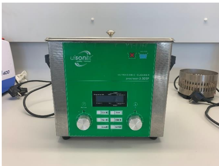
2.3 pav. Ultragarsinė įranga – Ulsonix Proclean 3.0DSP vonelė
