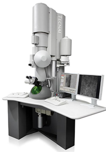
2.4 pav. Transmisinis elektronų mikroskopas TECNAI G2 F20 X-TWIN
