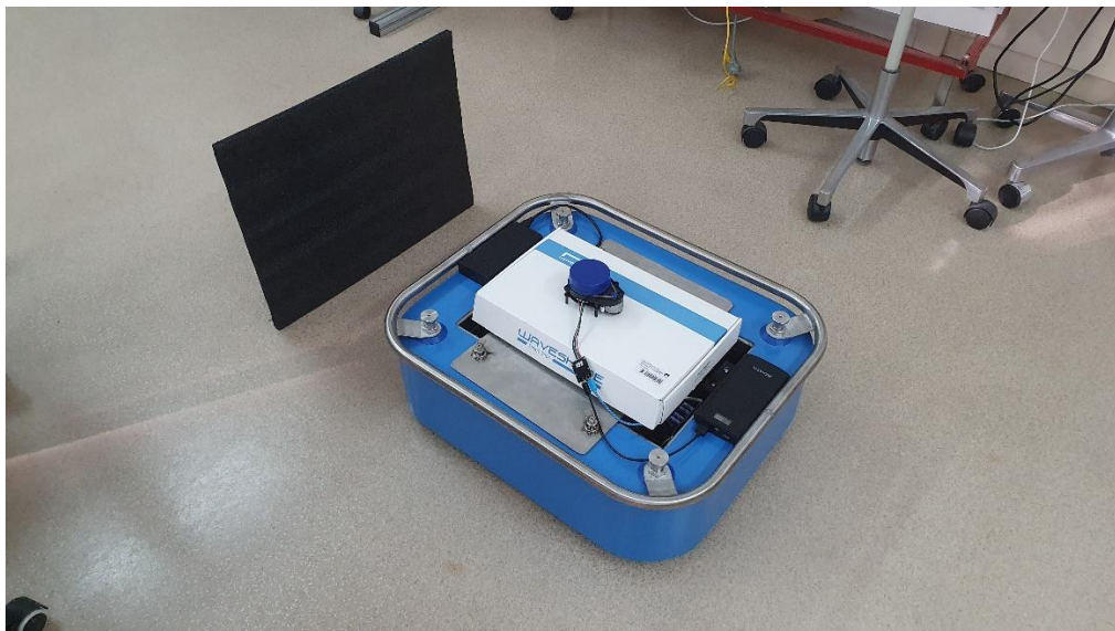
3.8 pav. Priešais robotą pastatytos kliūtis įvertinimas
