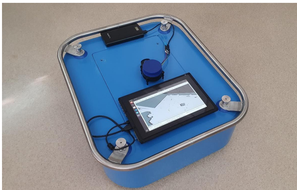
3.1 pav. Mobili robotinė platforma su lazeriniu atstumo jutikliu ir ekranu valdymui
