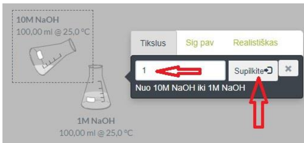
11 pav. 10M NaOH pilame į 1M NaOH tirpalą po 1 ml.
