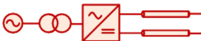
6 pav. HVDC vienpolės sistemos schema [6]
